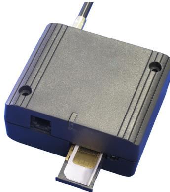
Abbildung 6.2.: GPRS Modem mit SIM Karte
