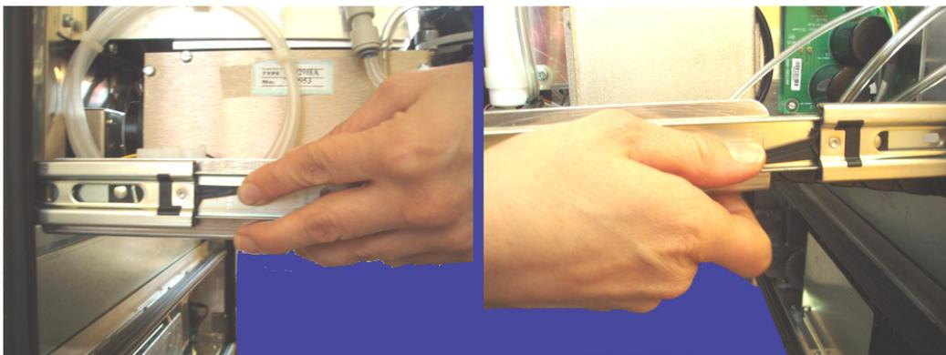
Abbildung 10.9.: Drücken Sie den kleinen Hebel links hinauf bzw. rechts hinunter
