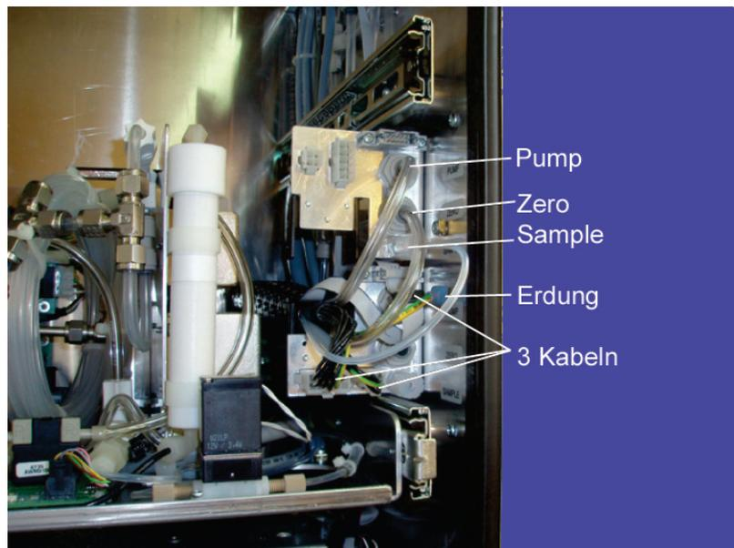
Abbildung 10.7.: Lösen Sie die sieben Anschlüsse der Verbindungskette
