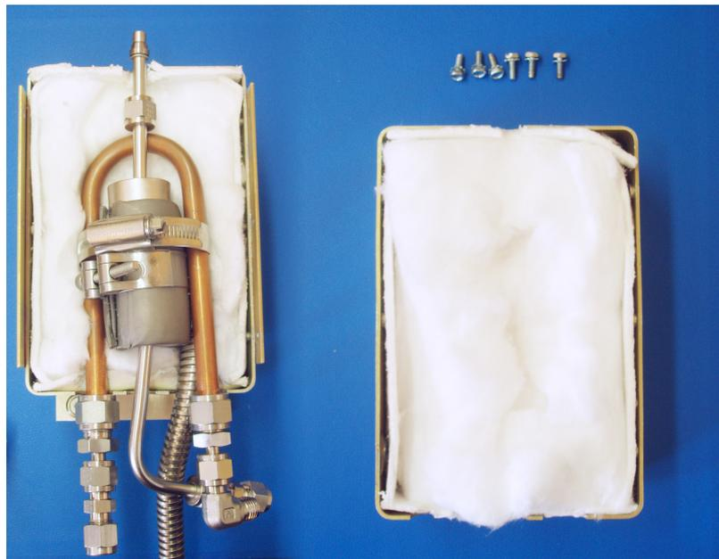
Abbildung 10.51.: Der offene Molybdänkonverter
