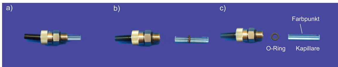
Abbildung 10.41.: Aufbau der Baugruppe Kapillare 1
