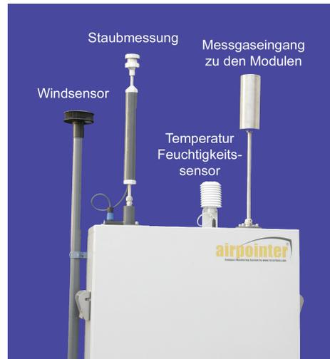
Abbildung 13.3.: Links seitlich: montierter Windsensor
