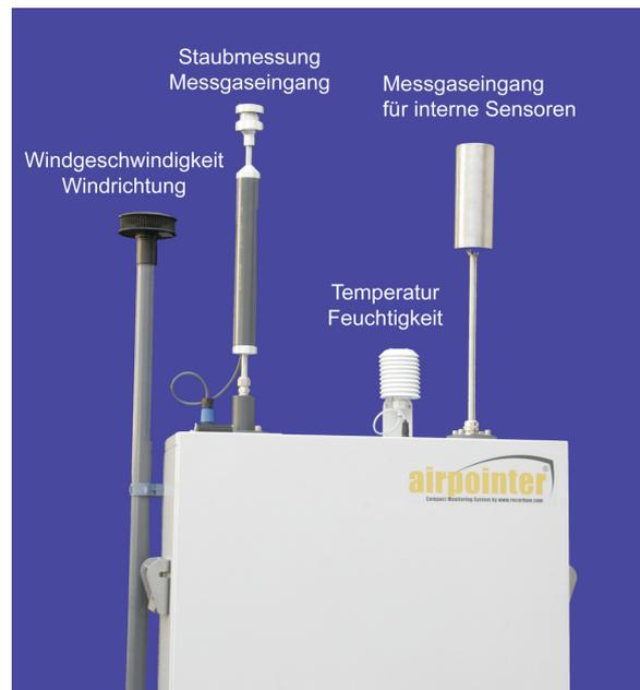
Abbildung 12.8.: Am Dach links befindet sich die Probenahme für das Staubmodul mit einem Messkopf für die PM10 Messung
