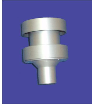
Abbildung 12.3.: Probenahmekopf PM10
