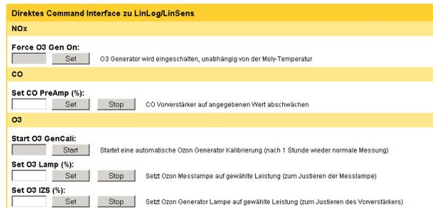
Abbildung 7.73.: Direktes Command Interface zu LinLog/LinSens
