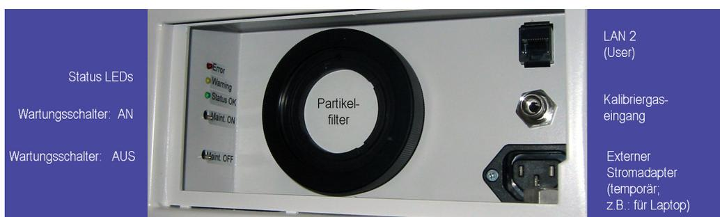
Abbildung 5.20.: Offene Wartungsklappe
