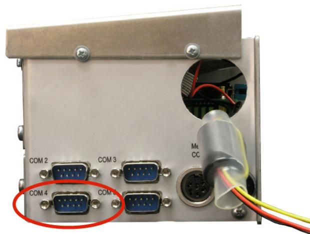
Abbildung A.1.: COM Anschluss zur Kommunikation über das AK und das Bayern/Hessen Netzwerkprotokoll. Das Bild zeigt den PC des airpointers von der rechten Seite.
