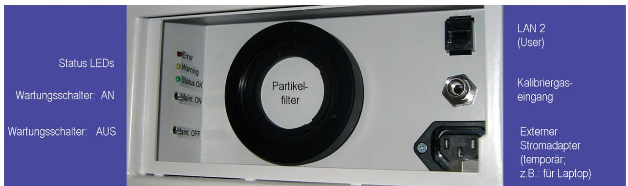
Abbildung 5.16.: Hinter der Wartungsklappe des airpointers
