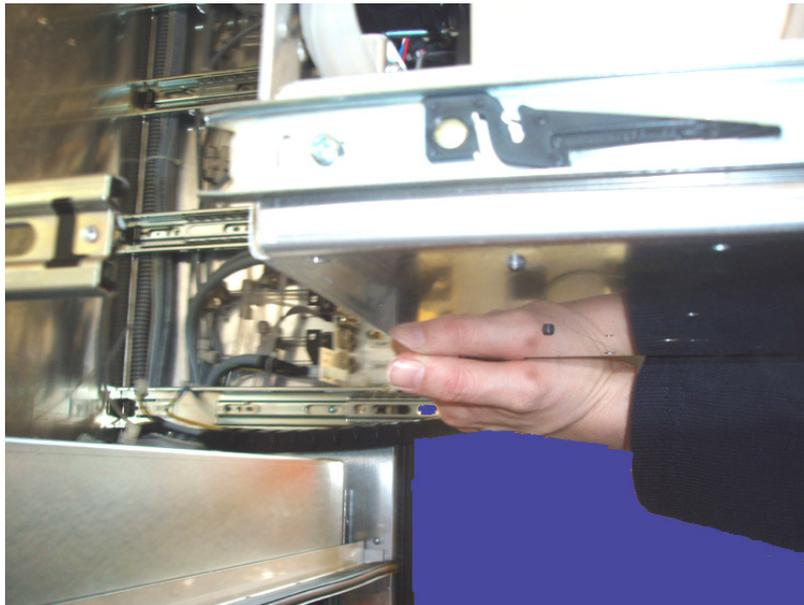
Abbildung 10.11.: Halten Sie das Modul in die Nähe des Schubfachs
