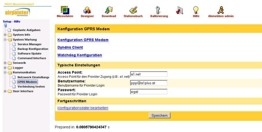
Abbildung 6.4.: Konfigurieren der Providereinstellungen für ein Modem (Kapitel 7.7.7.2 'User Interface → Setup → Kommunikation → GPRS Modem').
