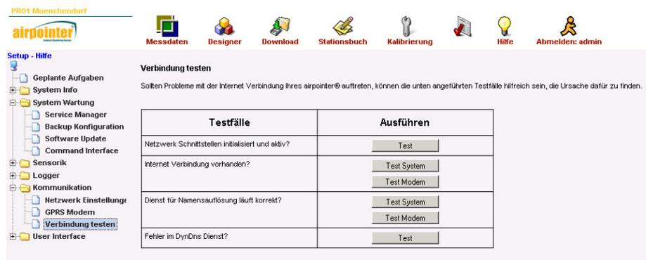
Abbildung 6.5.: Überprüfen der Internetverbindung
