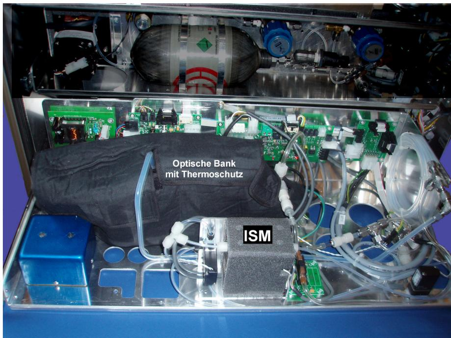
Abbildung 11.19.: Lokalisierung des ISM des SO<sub>2</sub> Moduls
