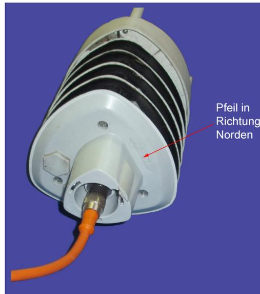
Abbildung 13.5.: Vaisala: Pfeil auf der Sensorunterseite zeigt in Richtung Norden
