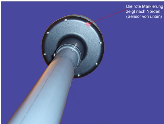
Abbildung 13.4.: Gill: Der rote Punkt auf der Sensorunterseite markiert Norden
