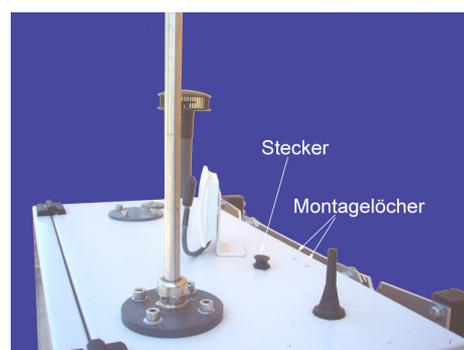
Abbildung 13.22.: Der Sensor wird stehend montiert
